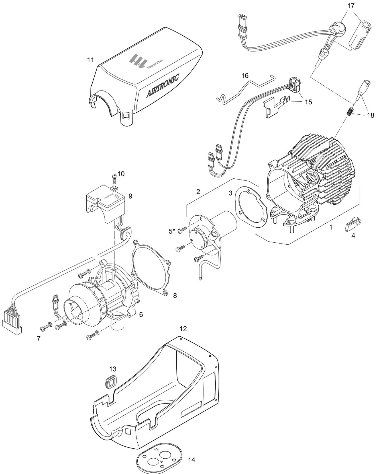
\* Airtronic Mでは4本のボルト M5 x 12により燃焼室を固定
