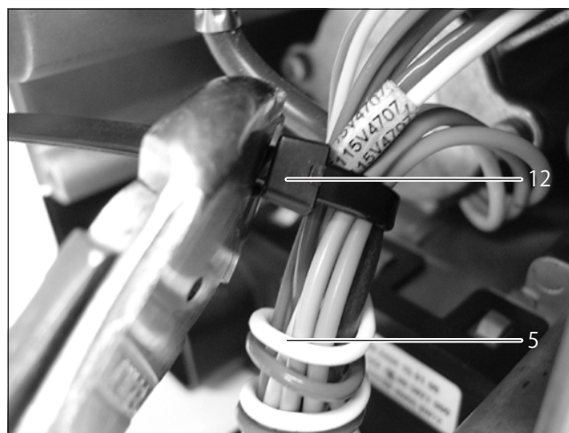
5 グロープラグ1の長ケーブル 12 ケーブルタイ(余分な長さはニッパーで切り取って ください)
