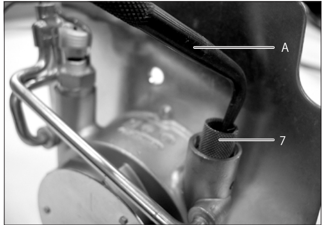
A ライニングを引っ張り出すための先端がとがったもの 7 ライニング
