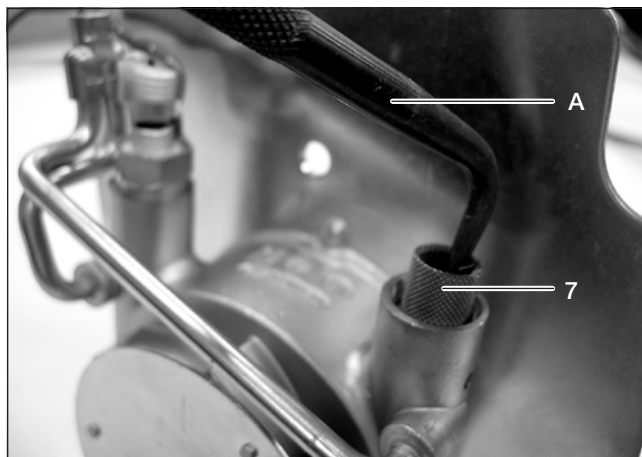
A Spetsigt föremål för att dra ut fodret. 7 Foder till glödstavsstuts
