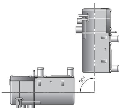
Допустимая установка с отклонением от стандартного положения вдоль продольной оси до  $90^\circ$ .
