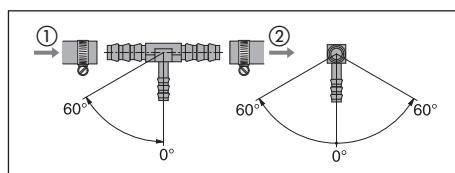
① Направление подачи – от топливного бака
