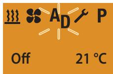
Через 10 секунд после отображения ДОПОЛНИТЕЛЬНЫЙ ПРИБОР OFF (Выкл) подсветка дисплея выключается.
