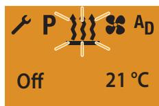
Через 10 секунд после отображения ОБОГРЕВ OFF (Выкл) подсветка дисплея выключается.
