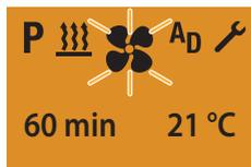
Режим отображения для воздушнонагревательных приборов при продолжительном режиме ВЕНТИЛЯЦИЯ.
